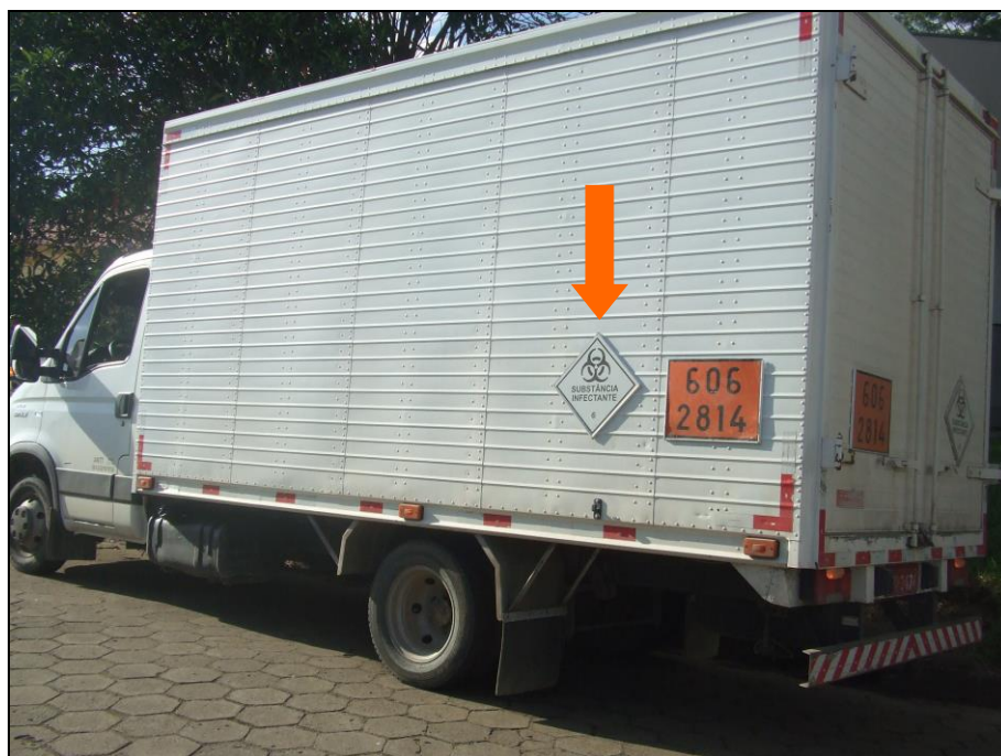
Figura 41 – Caminhão da empresa Santec Resíduos utilizado para coleta de RSS. No detalhe o símbolo de material infectante. Março de 2010.
